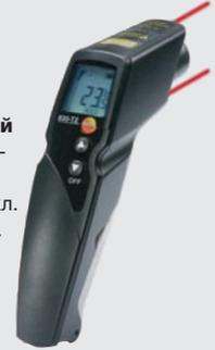
Быстродействующий универсальный ИК-термометр с 1-точечным лазерным целеуказателем и оптикой 10:1 в эргономичном дизайне "пистолета"
