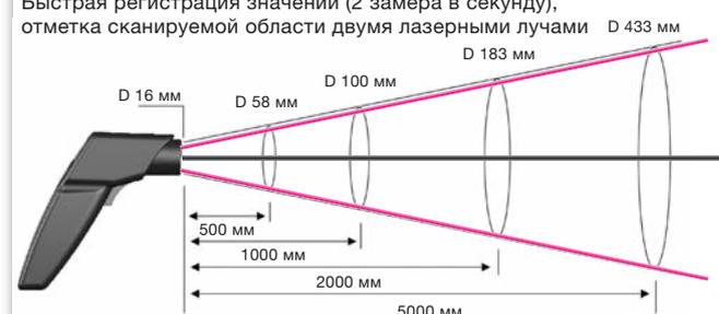
**Инфракрасный термометр с оптикой 30:1 для точного измерения поверхностной температуры объектов на расстоянии**
