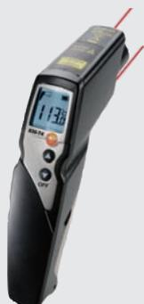
Рассчитанный на универсальное применение инфракрасный термометр testo 830-T4 оснащен 2-х точечным лазерным целеуказателем и оптикой 30:1. Данные поверхностной температуры, в том числе температуры малых объектов, могут быть получены с безопасного расстояния. Диаметр точки замера на расстоянии 1 метр составляет всего 36 мм. Еще большую гибкость при измерениях обеспечивают дополнительные внешние зонды.
