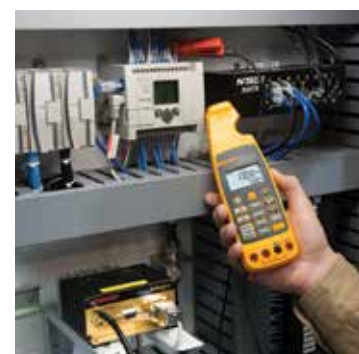
Измерение сигналов 4-20 мА без необходимости разрыва цепи
