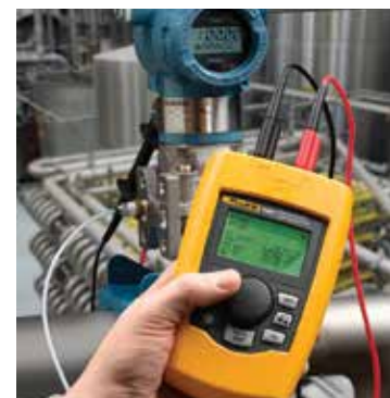
Калибраторы цепей Fluke надежны и точны. Модель 709Н позволяет базовый обмен информацией по HART (см. стр. 58).
