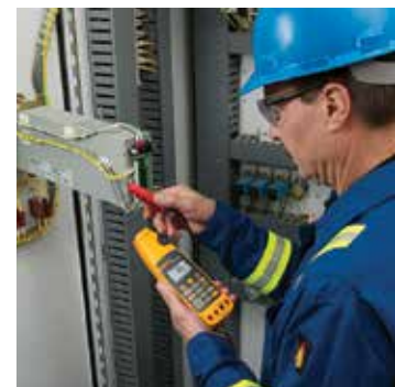
Измерение сигналов 4-20 мА без необходимости разрыва цепи
