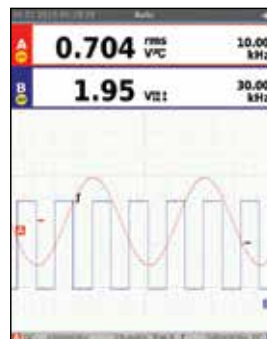
Система Fluke Connect-and-View™, срабатываемая по функции Auto Reading из технологии Fluke IntelliSet™, дает быстрый доступ к нужной информации.
