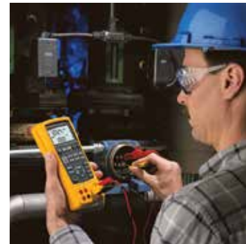
Простая калибровка измерительных преобразователей температуры с помощью калибраторов Fluke 725 и 726.
