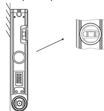
Плотно прижмите нижнюю сторону неподвижной линейки к вертикальной поверхности. Если поверхность строго вертикальна, пузырек вертикального уровня будет расположен между отметками на колбе.
