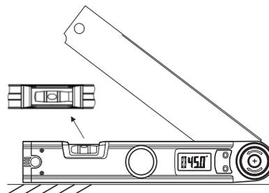
Установите неподвижную линейку на исследуемую поверхность. Если поверхность строго горизонтальна, пузырек горизонтального уровня будет расположен между отметками на колбе.
