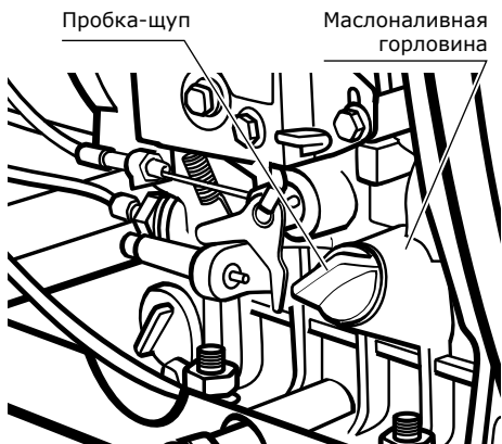
Рис. 11. Заполнение масляного картера и контроль уровня масла
