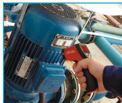
Отношение расстояния к размеру изображения D:S=12:1
