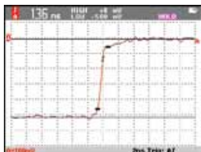
Минимальная длительность фронта импульса у прибора составляет 1,7 нс, что позволяет точно записывать сигналы с коротким фронтом и признаками отражений
