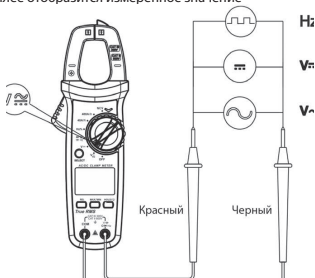
Рис. 3 Измерение напряжения переменного/постоянного тока и частоты
