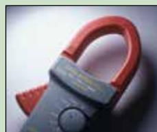
Серия имеет в составе модели с поистине уникальными характеристиками: губки с большим охватом (51 мм), датчик позволяющий снимать показания с проводников с током до 1000 А и никель-стальной сплав губок (в моделях с индексом "H") с малым гистерезисом.
