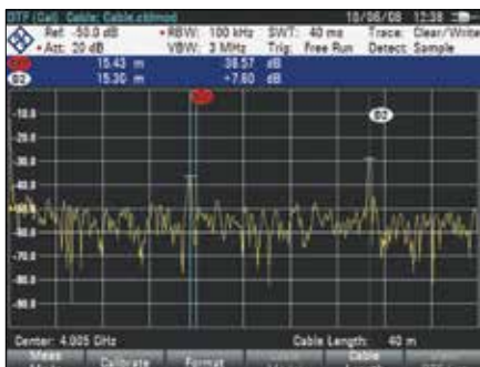
Измерение расстояния до места повреждения (DTF)
