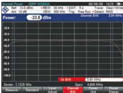
Измерение мощности в канале
