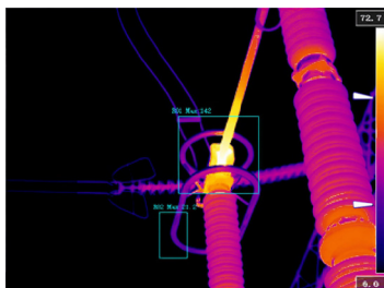
Тепловое изображение с цветовой шкалой, регулируемой вручную
