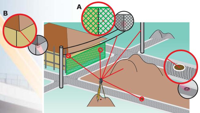
Тончайший луч дальномера позволяет с высокой точностью выполнить измерения на стены и углы зданий, люки колодцев, сетчатые ограждения и ветки деревьев.
