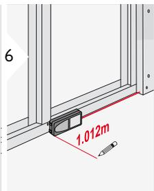
Медленно перемещайте прибор вдоль линии разметки. На дисплее отобразится расстояние до следующей разметки.
