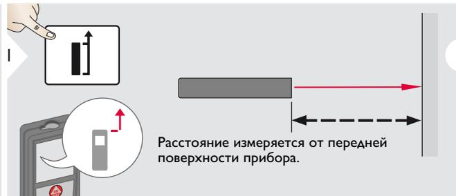
Расстояние измеряется от передней поверхности прибора.
